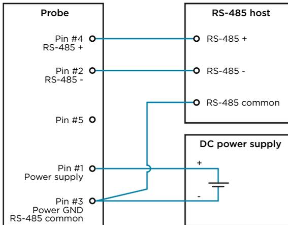
Figure 16 RS-485 wiring
