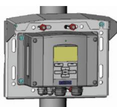
Montaż z wykorzystaniem osłony pogodowej
